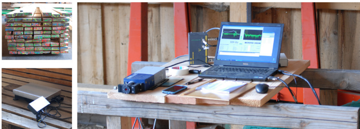
Abbildung 3– Der MOE_{dyn} steht stellvertretend für die Holzqualität, er ist ein direktes Maß für die Steifigkeit von Bauholz.
