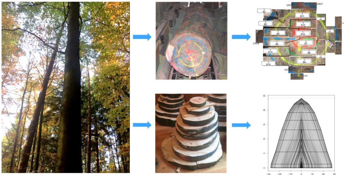
Abbildung 2– Für jedes Schnittholz waren die axiale und radiale Position im Baum bekannt. Ebenso wusste man das kambiale Alter und die Jahrringbreiten jedes Schnittholzes.
